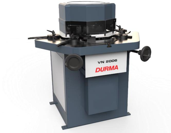
Máquina para cortar chapas de metal. Elas geralmente são movidas hidraulicamente. Equipados com uma lâmina em forma de V.
