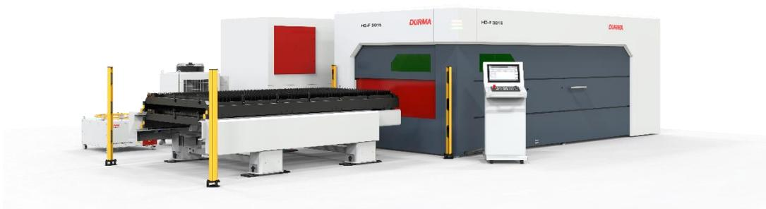
Laser 2D cabeçote foco automático Precitec LigthCutter Fiber, mesa adicional em espera, sistema de transmissão Óptica movimentação X e Y do cabeçote, alta velocidade com alta precisão, esteira recolhadora de cavacos e peças.
